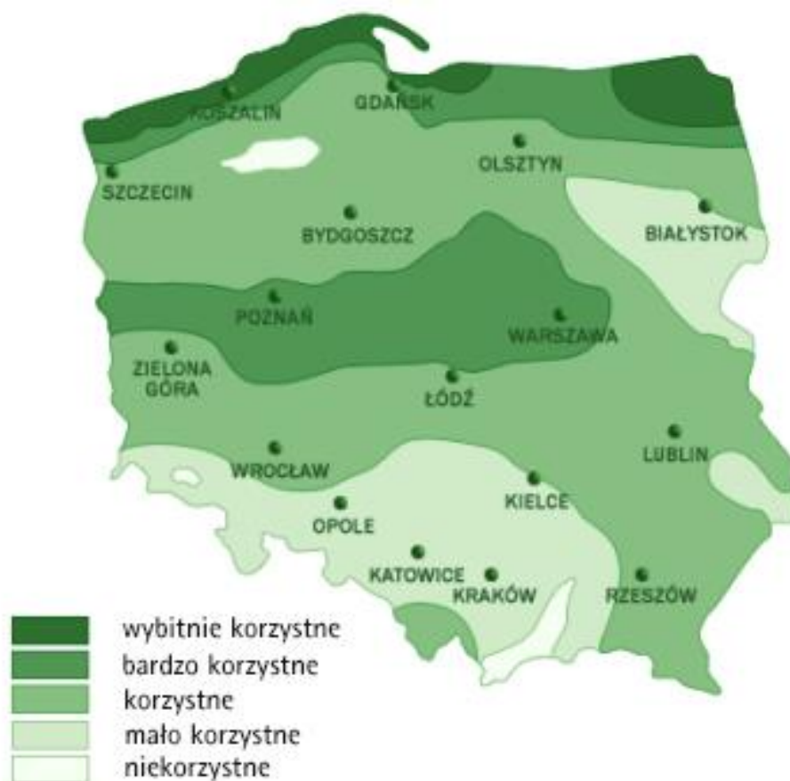
Rysunek 20. Strefy energetyczne warunków wiatrowych
